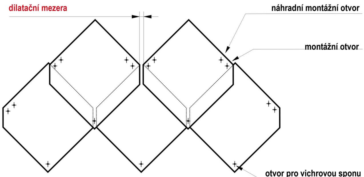
**SK3 – šupina** se přibíjí v místě připravených otvorů a ve spodní části se zajišťuje vichrovou sponou 25 x 27 mm. Při pokládce dojde k proklepnutí okraje spodní šupiny.
