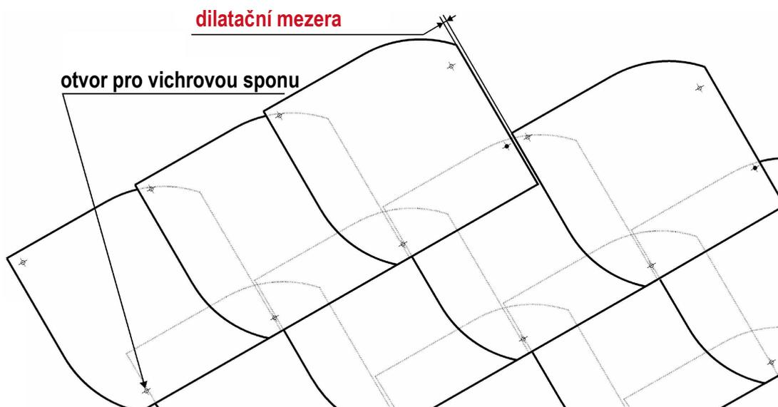
Ke střešní krytině **Capacco** dodáváme **měděné vichrové spony**, které se používají v jednom bodu správného třibodového uchycení.
